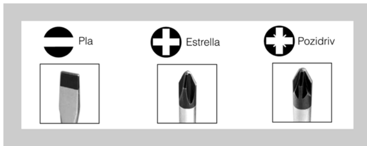
Figura 12. Tipus de tornavisos segons la punta
