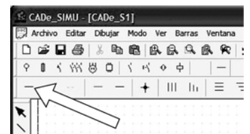
Selecció del cable de fase per fer la resta de connexions de l'esquema.
