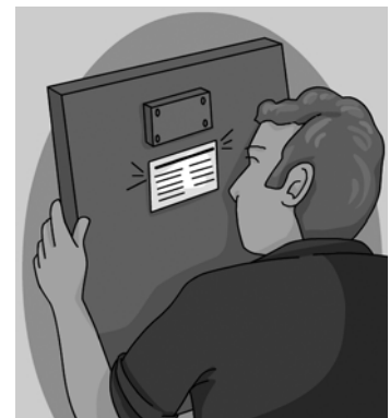
Tots els panells han de portar una etiqueta identificativa de les característiques elèctriques.
