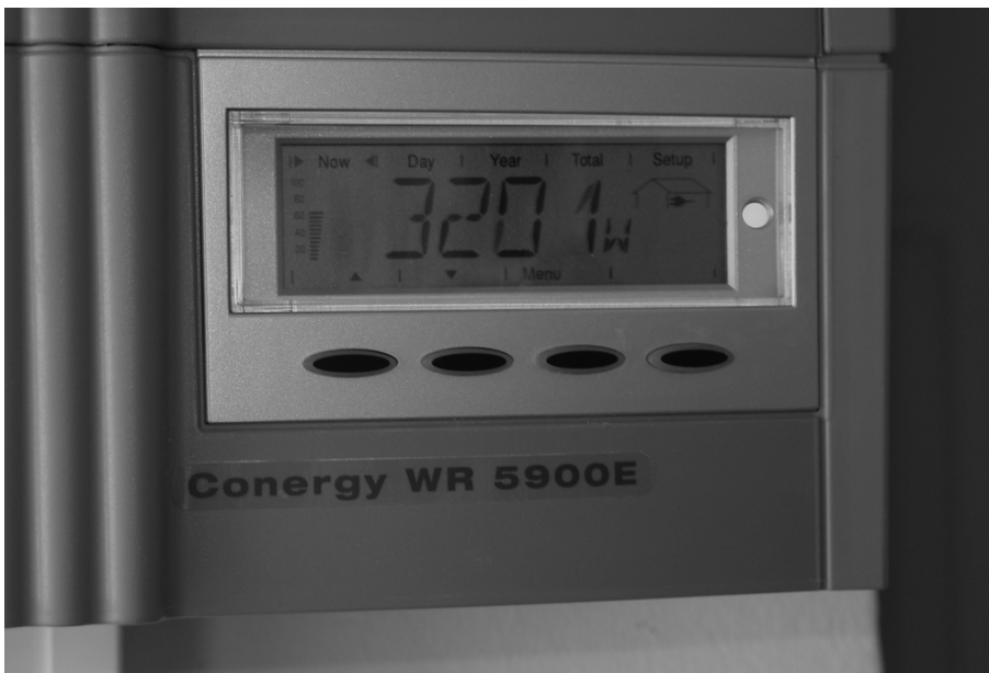
Figura 9. Panell informatiu d'un convertidor de connexió a la xarxa
